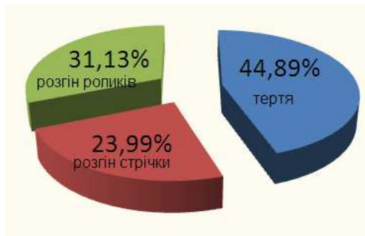
Рис. 2. Усереднений розподіл енергії при пуску конвеєрів
